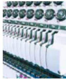
獨創的防護蓋安裝於天平桿外，避免了在高速運轉下繡線糾結在一起的情況，改善了工作環境的安全性。
